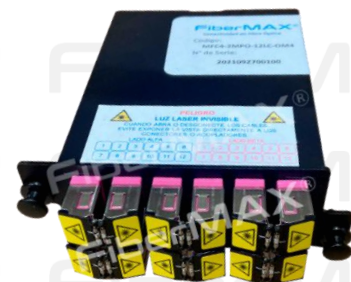
Cassette 2MPO-12LC-OM4 con acopladores con compuerta
